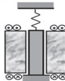
**Fig. 24:** Ferromagnetic-SMA actuator (Faran & Shilo, 2016)
